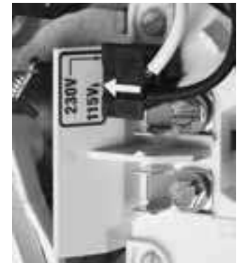
Figura 4B - Ficha de cambio de tensión configurada para 115 V.
