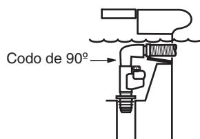
En algunos skimmers podría ser necesario instalar un conector de codo para impedir que la manguera se enrede. En skimmers profundos, instale el codo de 45-grados entre el regulador de flujo y la manguera. Puede usar el codo de 90 grados para skimmers poco profundos.
