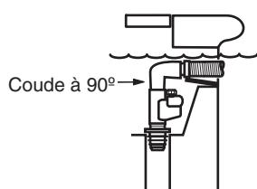
Sur certains skimmers, il peut s'avérer nécessaire d'installer un connecteur coudé pour empêcher la torsion du tuyau. Avec les skimmers profonds, installer un coude à 45 degrés entre le régulateur de débit et le tuyau. Avec les skimmers peu profonds, utiliser un coude à 90 degrés.
