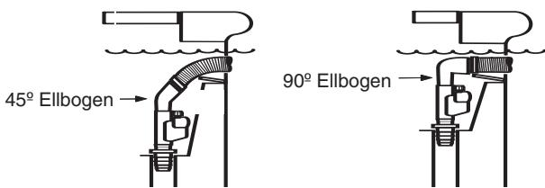
Es kann sein, dass man bei manchen Schaumlöffeln eine Ellbogenverbindung installieren muss, damit sich der Schlauch nicht verdreht oder umknickt. Für tiefe Schaumlöffel installiert man zwischen dem Strömungsregler und dem Schlauch einen 45-Grad Ellbogen. Für flache Schaumlöffel nimmt man einen 90-Grad Ellbogen.
