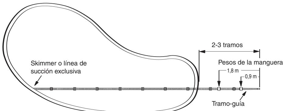
**Nota:** En piscinas de menos de 1.5 metros de profundidad, quite la peso del tramo-guía y posiciónela sobre la manguera normal, a una distancia de cuatro pies del Polaris.
