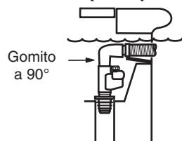
Per evitare che il tubo si attorcigli, in alcuni skimmer può rendersi necessario installare un raccordo a gomito. Per skimmer profondi, installare un gomito a 45 gradi tra il regolatore di flusso e il tubo flessibile. Per skimmer poco profondi, usare un gomito a 90 gradi.
