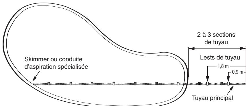
**Remarque :** Dans les piscines ayant moins de 1,5 m de profondeur, retirer les lestes du tuyau principal et les replacer sur le tuyau standard, à 1,2 m du Polaris.
