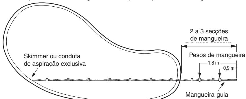
**Observação:** Para piscinas com menos de 1,5 m, retire o peso da mangueira-guia e coloque-o na mangueira padrão a uma distância de 1,2 m do Polaris.
