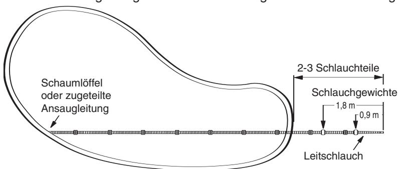
**Hinweis:** Bei Pools die nicht mehr als 1,50 m tief sind, sollen die Gewichte vom Leitschlauch entfernt werden und an den Standardschlauch, 1,20 m vom Polaris entfernt, befestigt werden.
